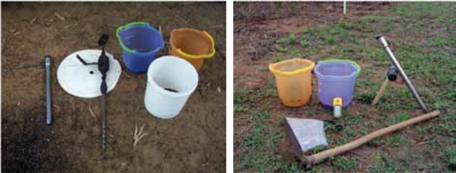
Figure 37. Des outils et des équipements manuels utilisés pour l'échantillonnage de sol.
