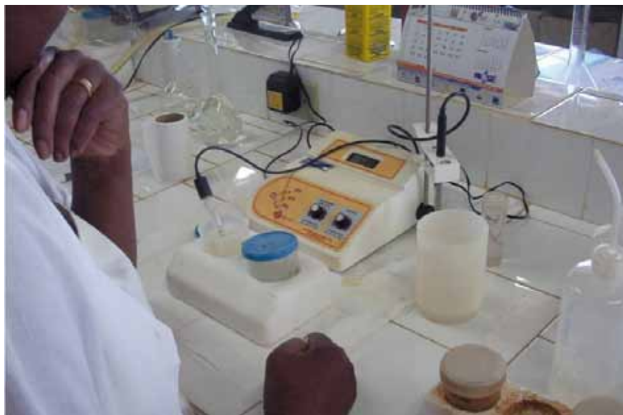
Figure 35. Mesure du potentiel hydrogène (pH) du sol.
